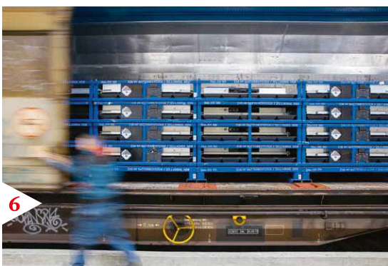
6 — Die Hochvoltbatterie ist modular aufgebaut und enthält bis zu zwölf Batteriemodule mit jeweils 24 Lithium-Ionen-Zellen.
