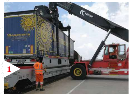
1 — Mit der mobilen Wanne des CargoBeamer-Systems können auch nicht-kranebare Trailer umgeschlagen werden.
